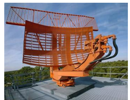
Radar primaire typique à faisceau plat d'un aéroport →
