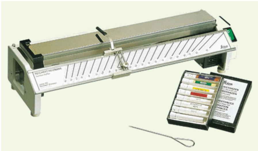
Le banc Köfler permet de mesurer la température de fusion d'une espèce chimique
