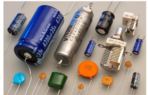
Le condensateur est caractérisé par le coefficient de proportionnalité entre charge et tension, appelé **capacité électrique C** et exprimé en farads (symbole : F).
